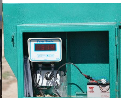
Fotos del ensayo de tratamientos con presión 300 kPa y 200 kPa. Cosecha mecánica y pesado del grano con remolque pesador de cada una de las repeticiones de los tratamientos.
